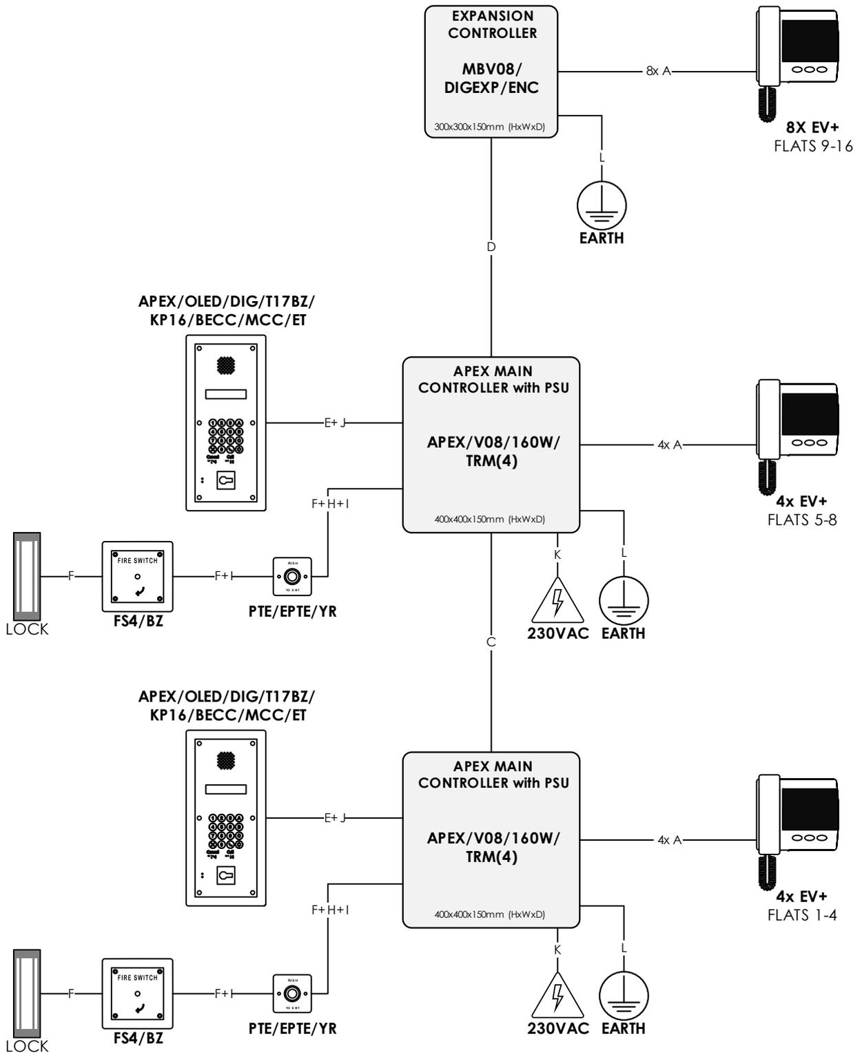
**FIGURE 1 - MINIMUM CABLE REQUIREMENTS**
