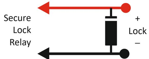
FIGURE 24 - 1N4007 DIODE FITTED AT LOCK
